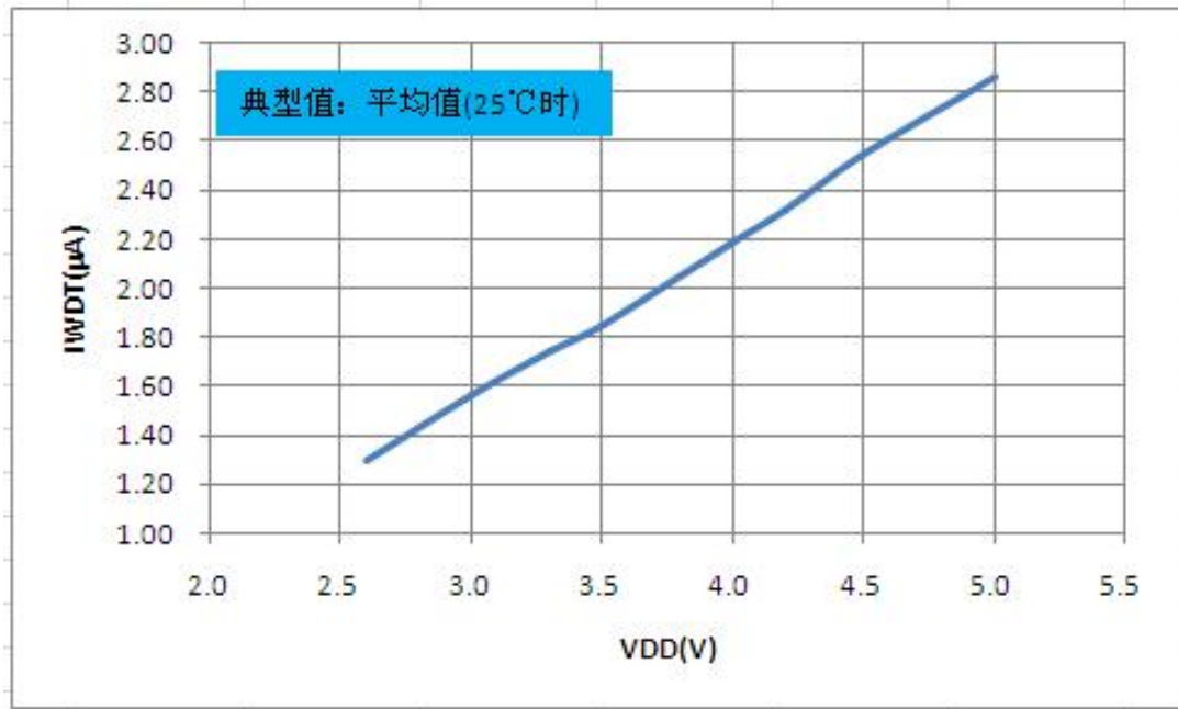
图18.5:看门狗电流 I_{WDT} - VDD关系曲线图
