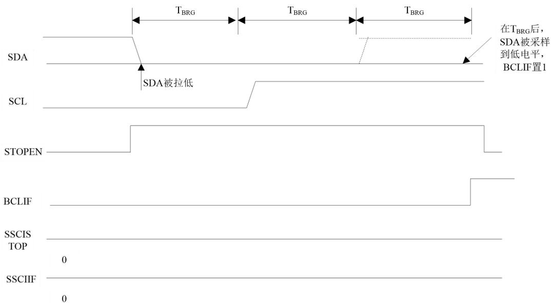
图9.26 停止条件期间的总线冲突（情形1）
