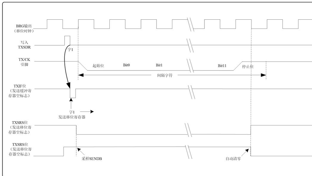
图 10.6 发送间隔字符时序
