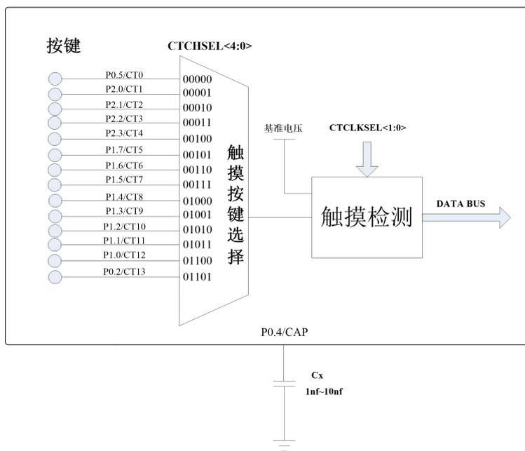
图 11.1 电容触摸原理
