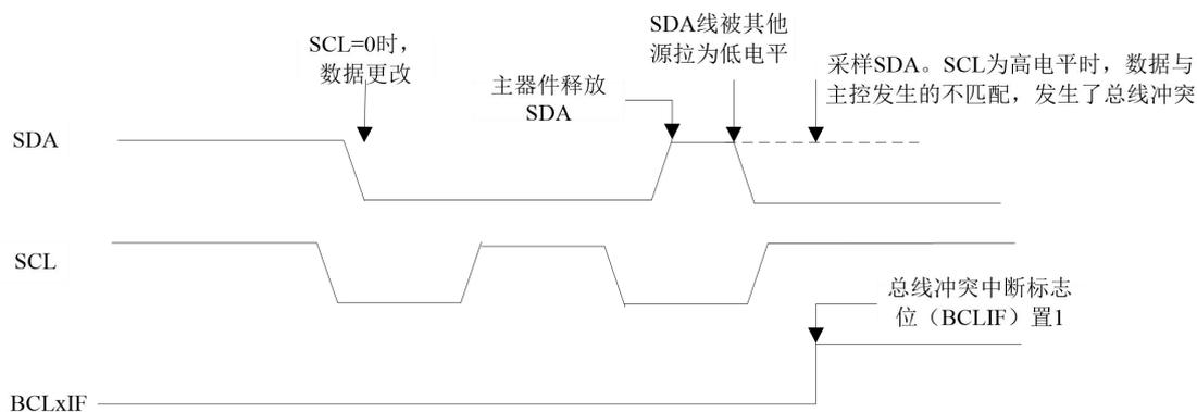
图 9.20 发送和应答时的总线冲突时序
