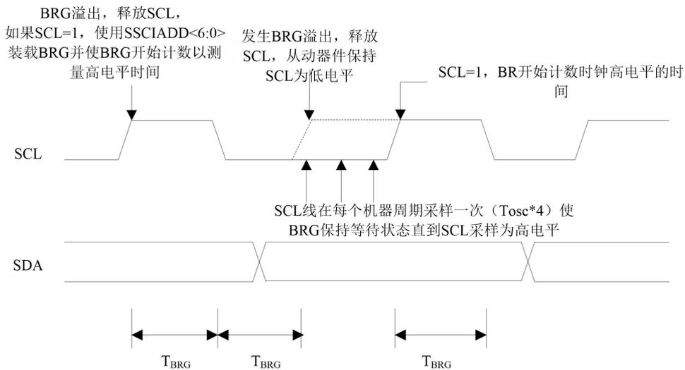
图 9.19 主控发送模式下的时钟仲裁时序
