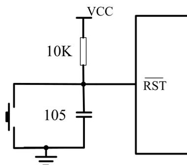
图 14.2 建议  $\overline{\text{RST}}$  复位电路
