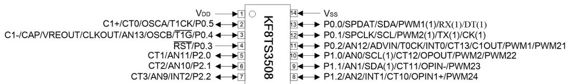
注: 1、用户在正常使用时, 通常会有一些用不到的引脚, 如果直接把这些管脚悬空, 而不做其他处理可能使单片机功耗增大, 因此建议将那些不用的引脚设置为数字输出模式, 如果P0.3未用, 应外接上拉电阻, 并对地下拉一个电容。
