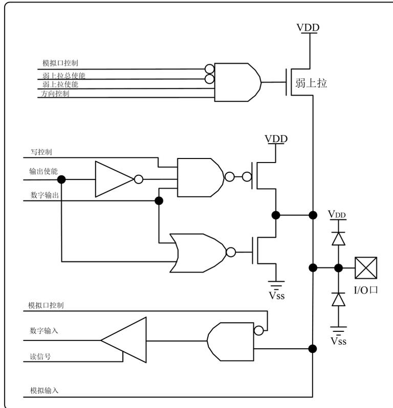
图 2.5 P2 口引脚原理功能框图
