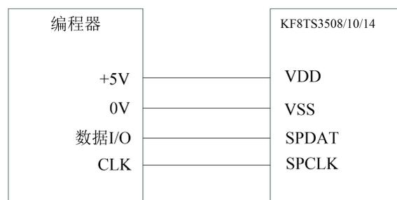
图 1.11 在线串行编程连接图
