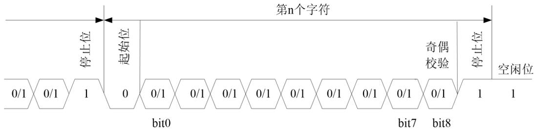
图 10.7 全双工异步通信数据结构图
