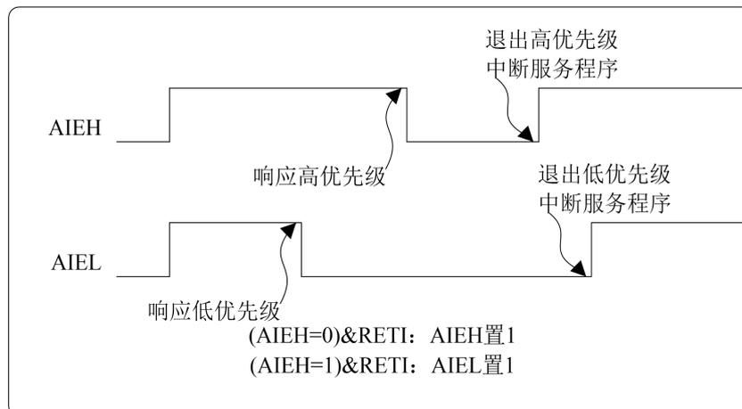
图 5.1 中断优先级工作原理图
