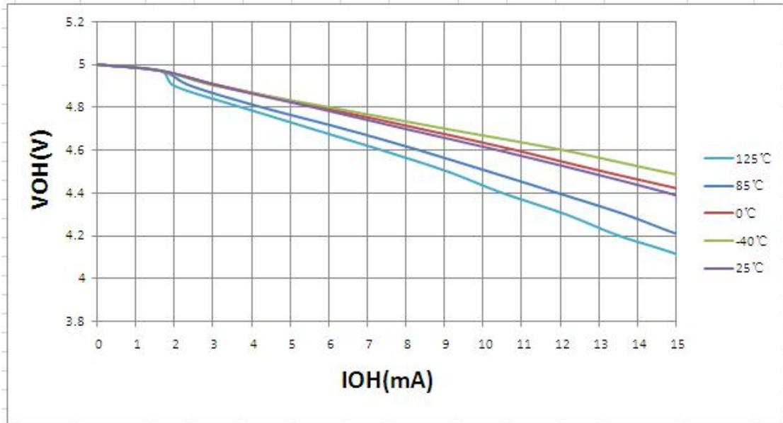
图18.8: VOH – IOH 关系曲线图 (VDD = 3.0V)
