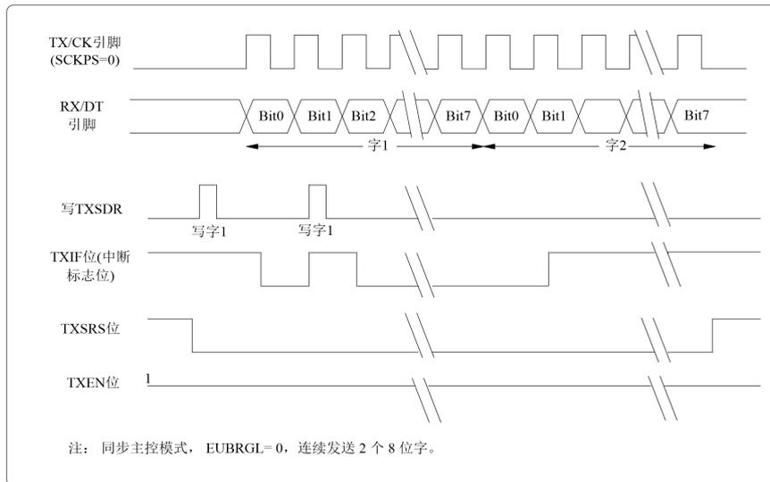
图 10.12 半双工同步发送 (SCKPS<sub>x</sub>=0)
