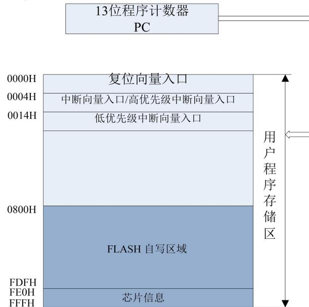
图 3.3 KF8TS3508/3510/3514 程序存储器映射
