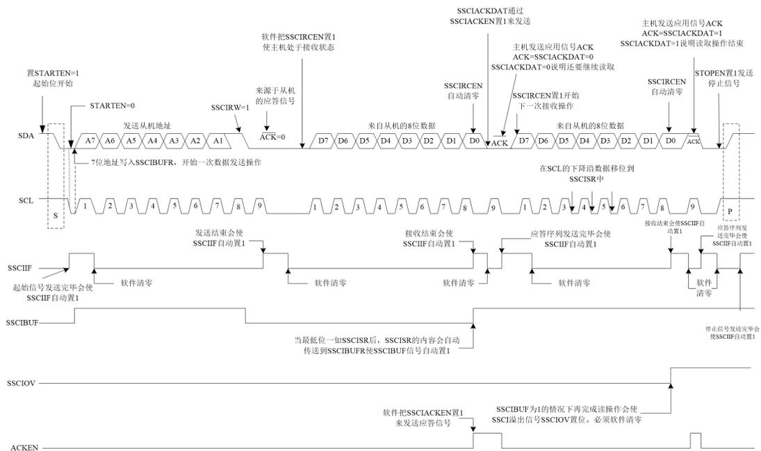
图9.16 I2C主模式接收数据时序图（7位地址）
