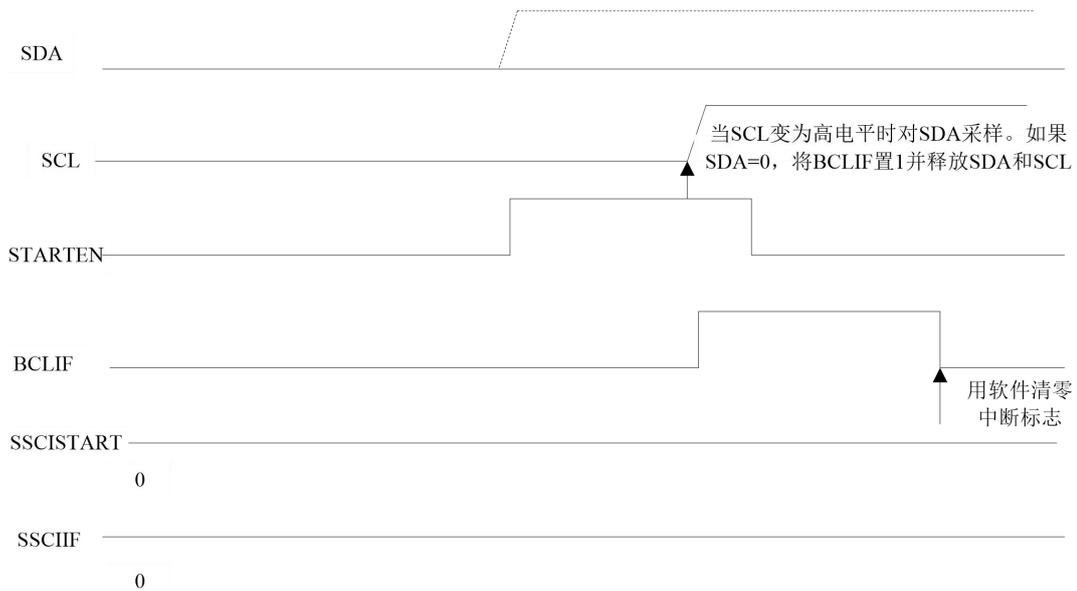
图 9.24 重复启动条件期间的总线冲突（情形 1）
