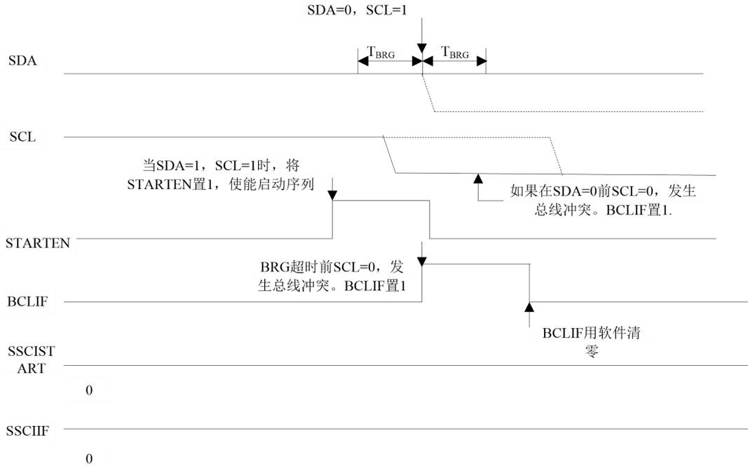
图9.22 启动条件期间的总线冲突 (SCL=0)
