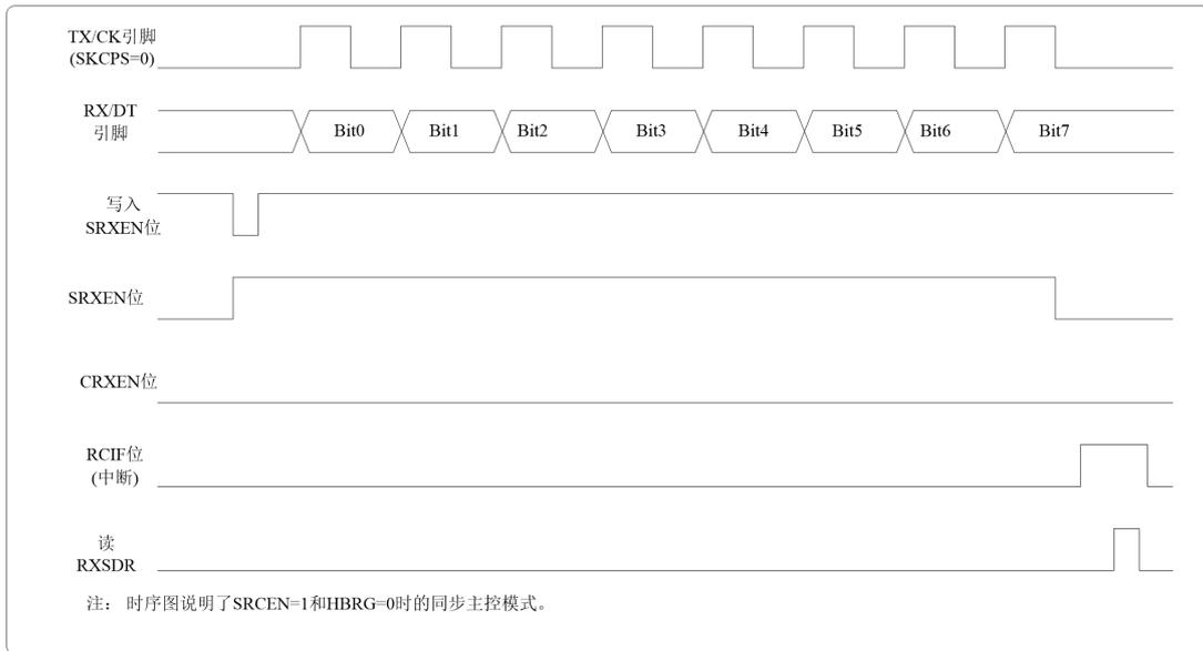
图 10.15 半双工同步接收（主控模式，SRXEN=1，SCKPS=0）
