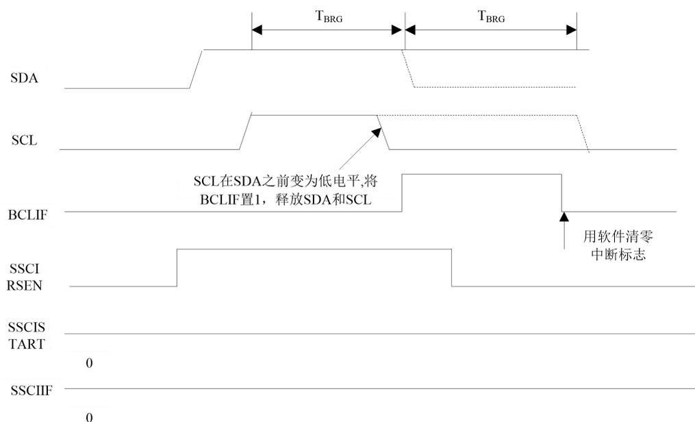
图 9.25 重复启动条件期间的总线冲突（情形 2）
