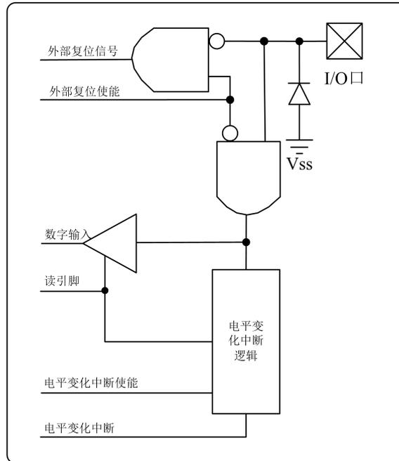
图 2.2 引脚 P0.3 原理功能框图
