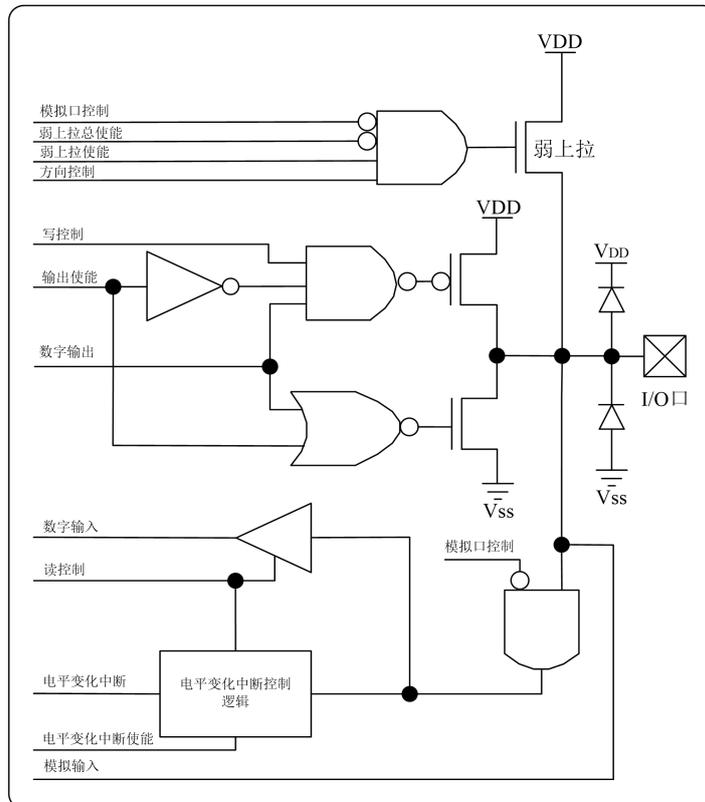
图 2.3 P0.0~P0.2、P0.4~P0.5 口引脚原理框图
