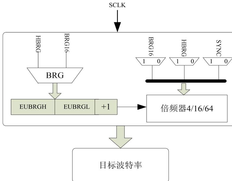
图 10.2 USART 目标波特率产生原理框图
