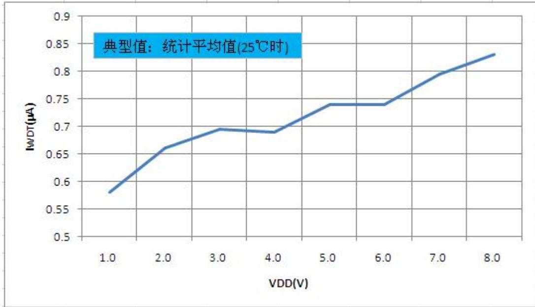
图 18.6:欠压复位电流 ILVR - VDD 关系曲线图
