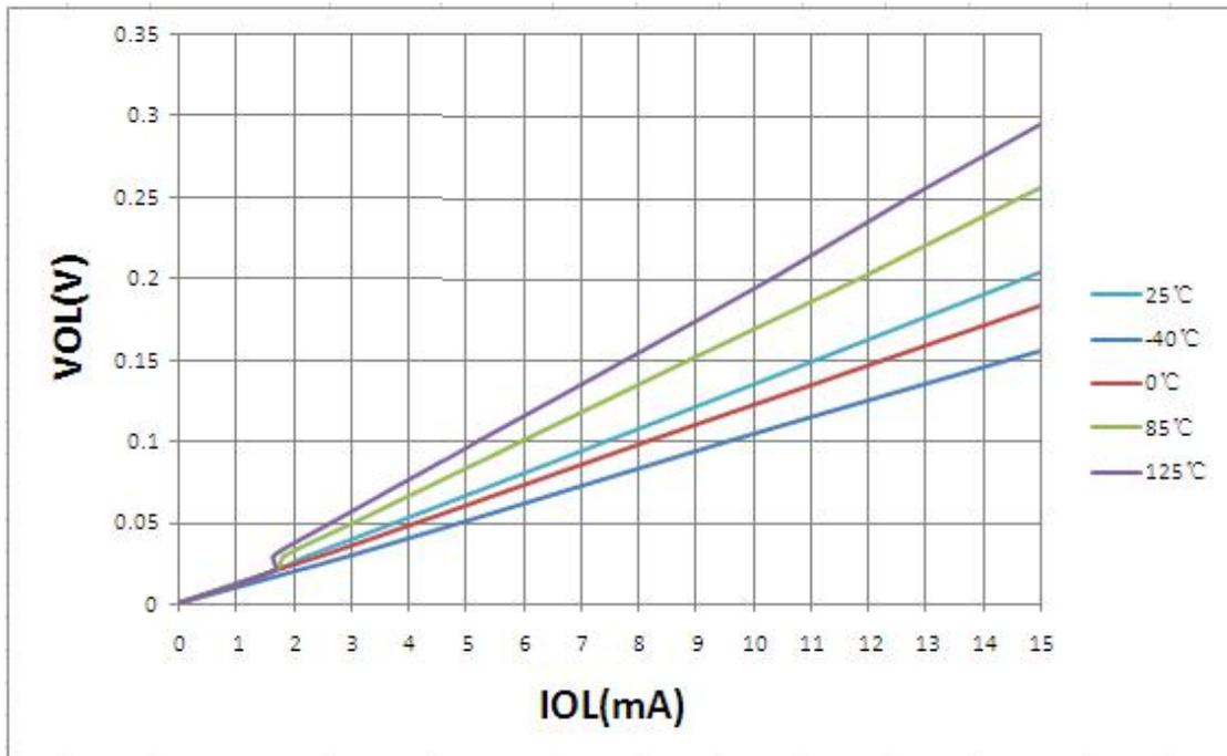
图18.10: VOL — IOL 关系曲线图 (VDD = 3.0V)
