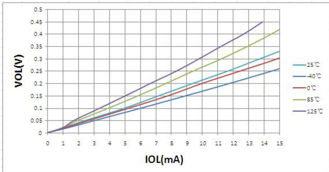
图18.11: 不同温度时VOP—IOP 关系曲线图 (VDD =5.0V)
