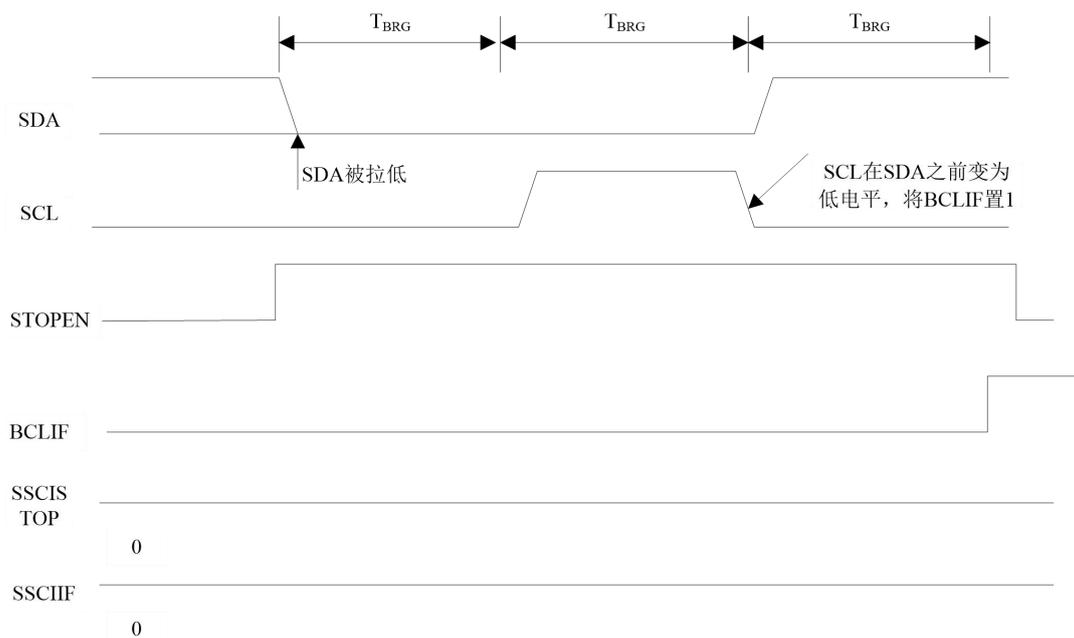
图9.25 停止条件期间的总线冲突（情形2）
