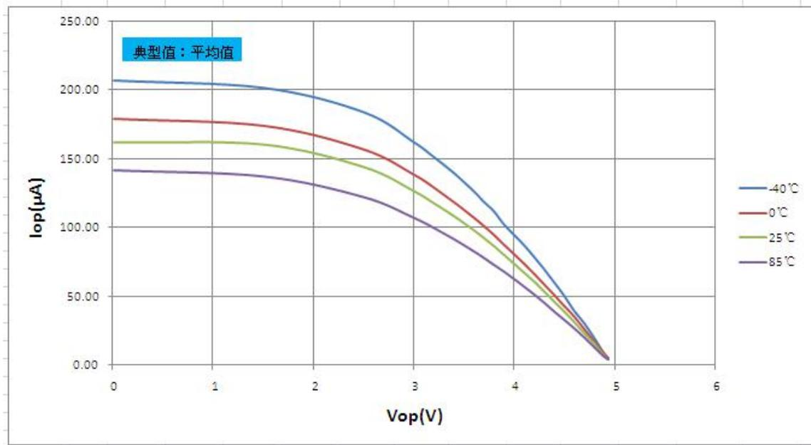
图 18.12: 不同温度时 VOP—IOP 关系曲线图 (VDD =3.3V)
