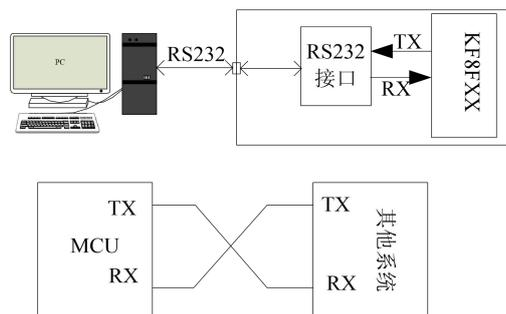
图 10.8 串口通信原理框图
