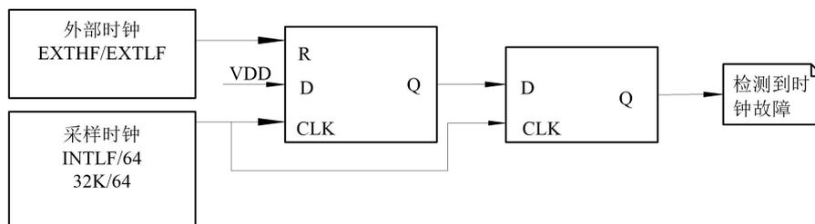
图 1.8 时钟故障检测原理图
