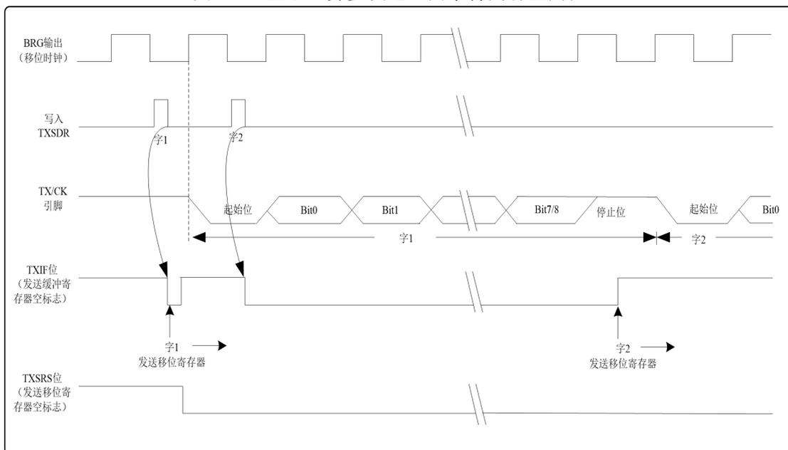
图 10.10 全双工异步发送（一字符接一字符）
