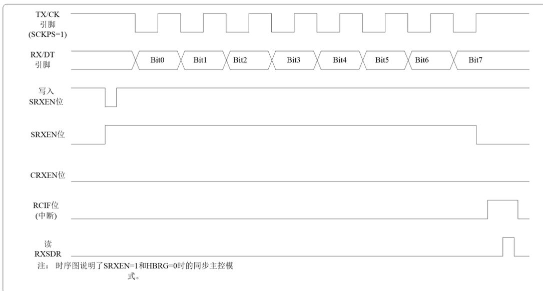
图 10.16 半双工同步接收（主控模式，SRXEN=1，SCKPS=1）
