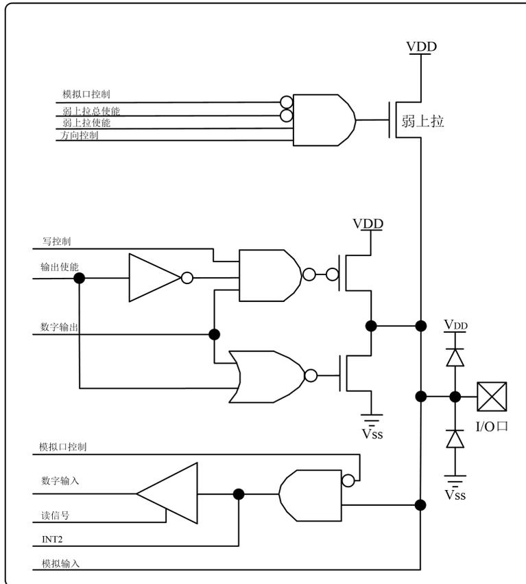
图 2.4 P1 口引脚原理功能框图
