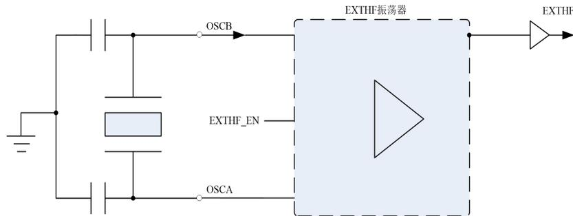
图 1.4 EXTHF 振荡器原理图
