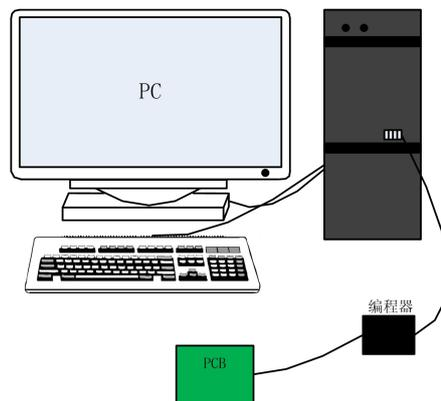
图 1.11 在线调试系统示意图
