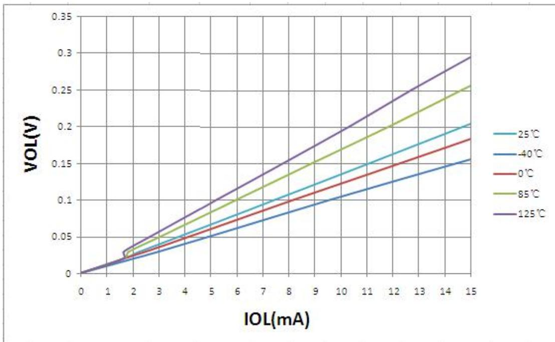
图19-11:不同温度时VOL – IOL 关系曲线图 (VDD = 3.0V)
