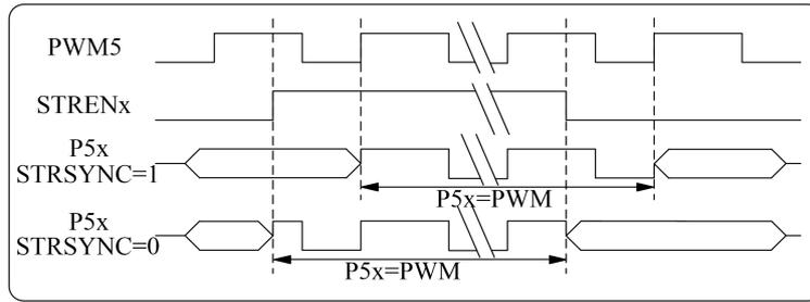
图 9.8 单输出模式 PWM 输出引脚切换
