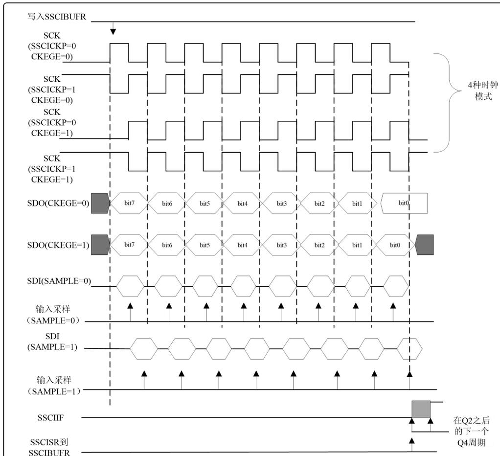
图 12.30 SPI 主控模式时序图
