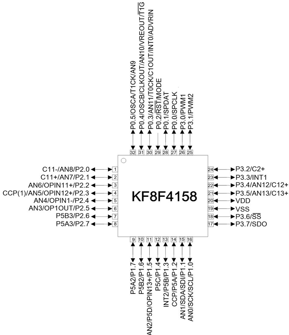
注：1、用户在正常使用时，通常会有一些用不到的引脚，如果直接把这些管脚悬空，而不做其他处理可能使单片机功耗增大，因此建议将那些不用的引脚设置为数字输出模式，如果P0.2未用，应外接上拉电阻,并对地下拉一个电容。
