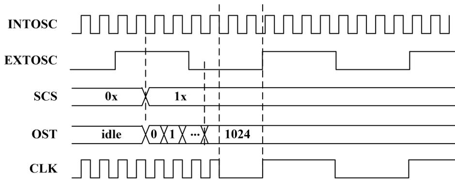
图 1.8 切换至外部时钟源时时钟信号同步时序图
