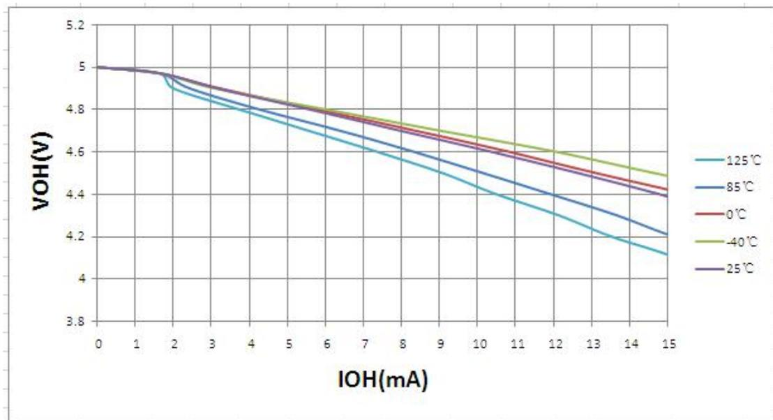
图19-9:不同温度时VOH — IOH 关系曲线图 (VDD = 3.0V)
