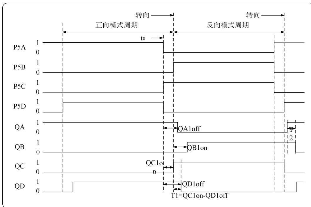
图 9.18 接近满占空比时换向时信号示例
