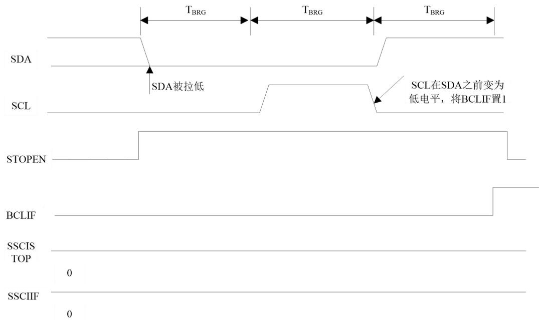
图12.27 停止条件期间的总线冲突（情形2）
