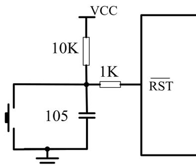
图 15.2 建议  $\overline{\text{RST}}$  复位电路
