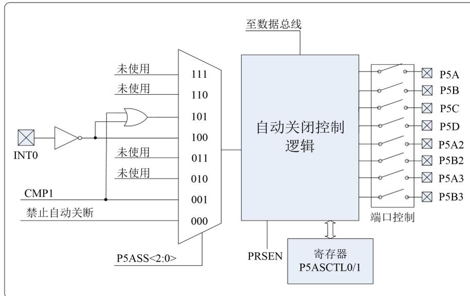
图 9.19 自动关断模式原理框图
