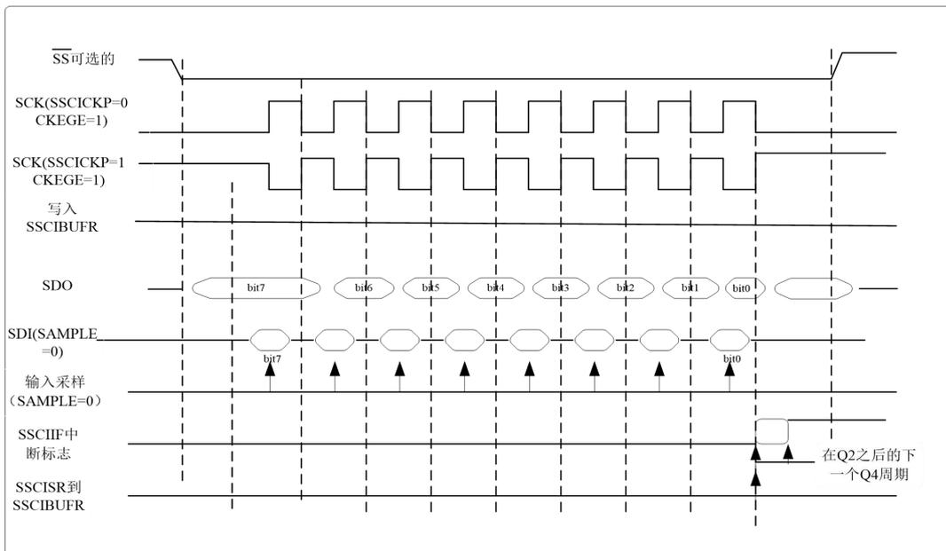
图 12.33 SPI 模式时序图（从动模式且 CKEGE=1）
