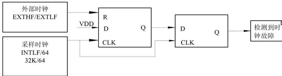
图 1.9 时钟故障检测原理图
