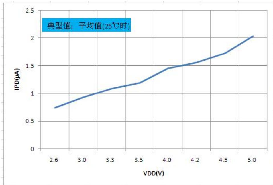
图19-3: 弱上拉电流 $I_{PUR}$  — VDD 关系曲线图
