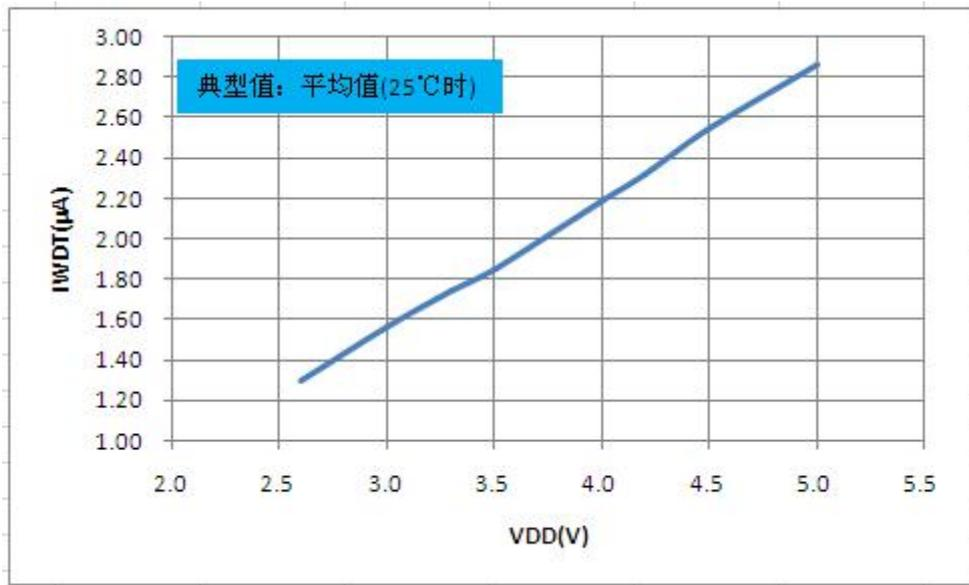
图19-6:比较器电流 — VDD关系曲线图 (使能一路比较器)
