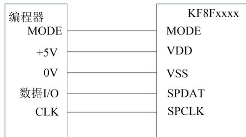
图 1.12 在线串行编程连接图
