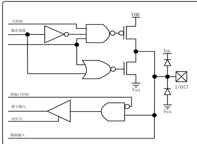
图 2.6 P3 口引脚原理功能框图
