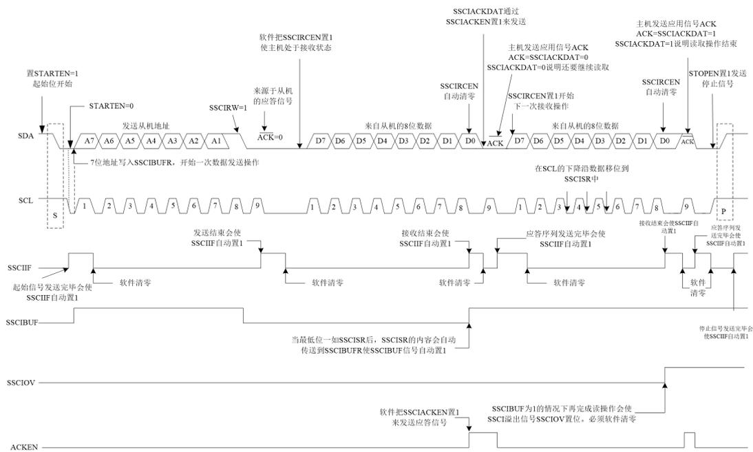
图12.16 I2C主模式接收数据时序图（7位地址）
