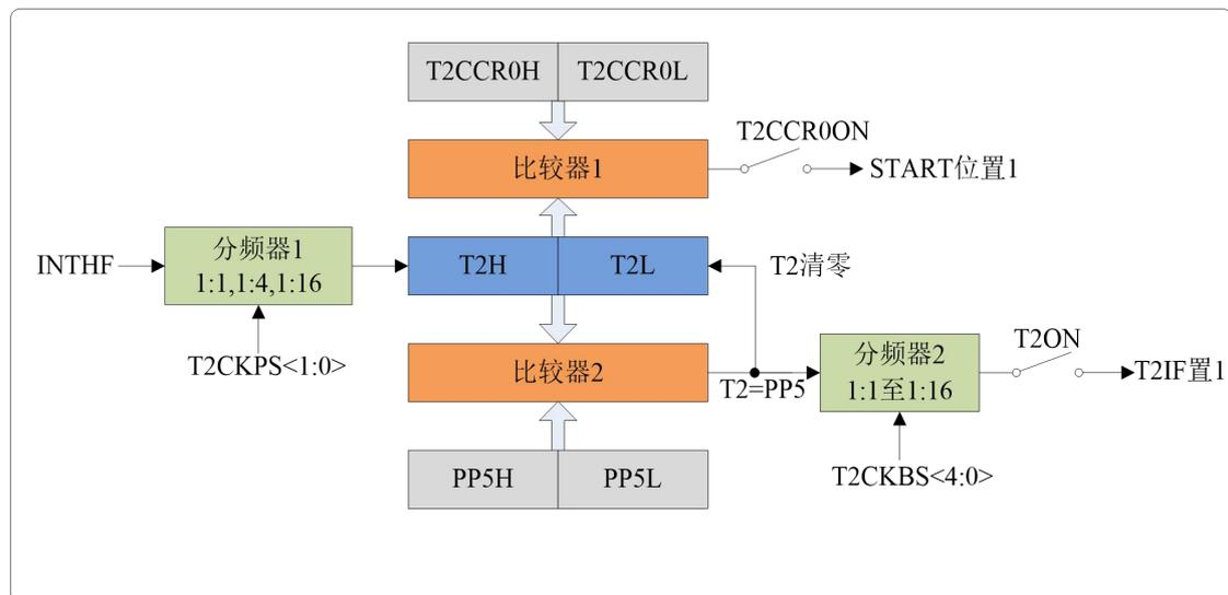
图 6.3 定时器 T2 原理框图
