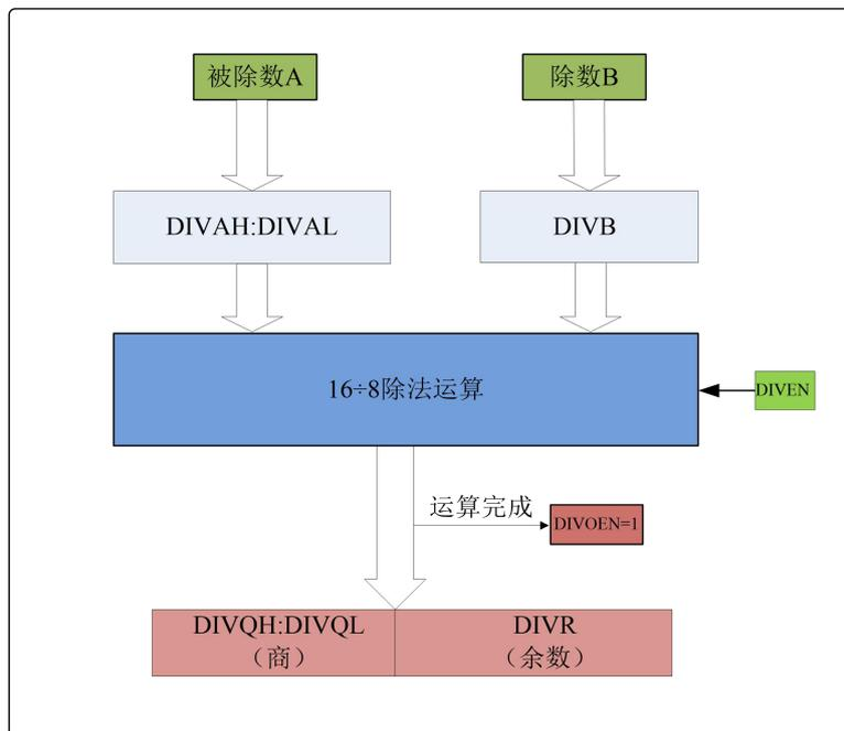
图 14.1 硬件除法器原理框图
