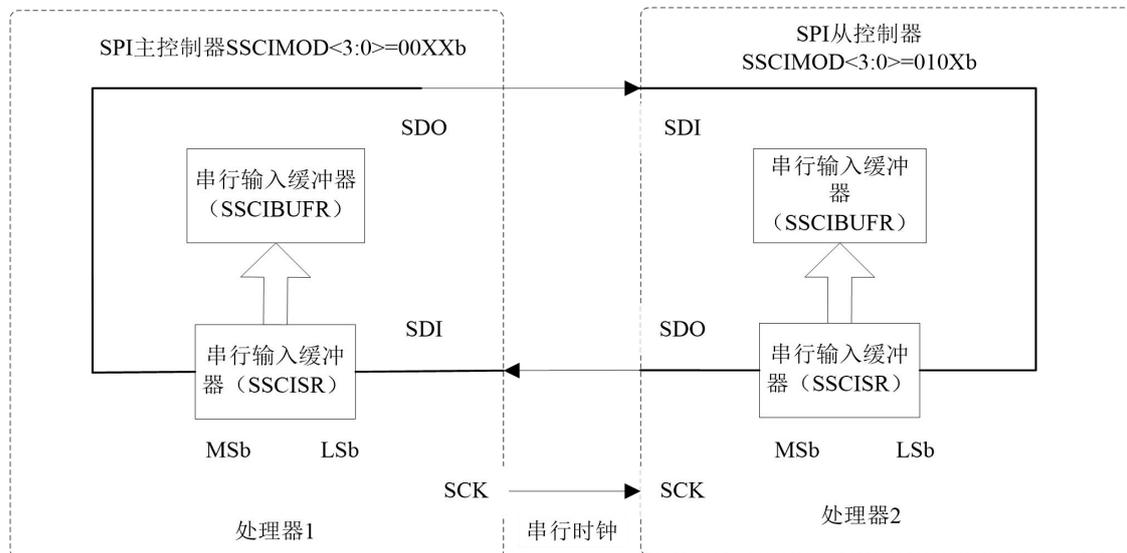
图 12.29 SPI 主从控制器连接
