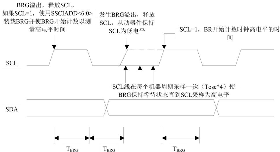
图 12.19 主控发送模式下的时钟仲裁时序
