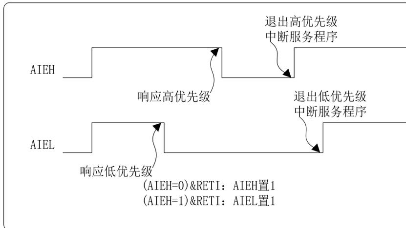
图 5.1 中断优先级工作原理图
