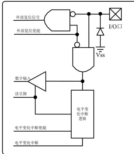
图 2.2 引脚 P0.2 原理功能框图
