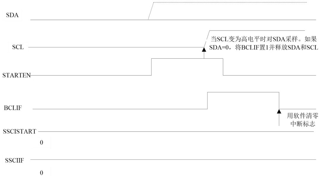
图 12.24 重复启动条件期间的总线冲突（情形 1）
