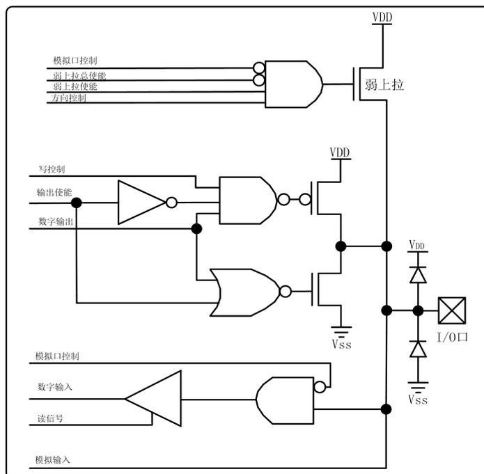
图 2.5 P2 口引脚原理功能框图
