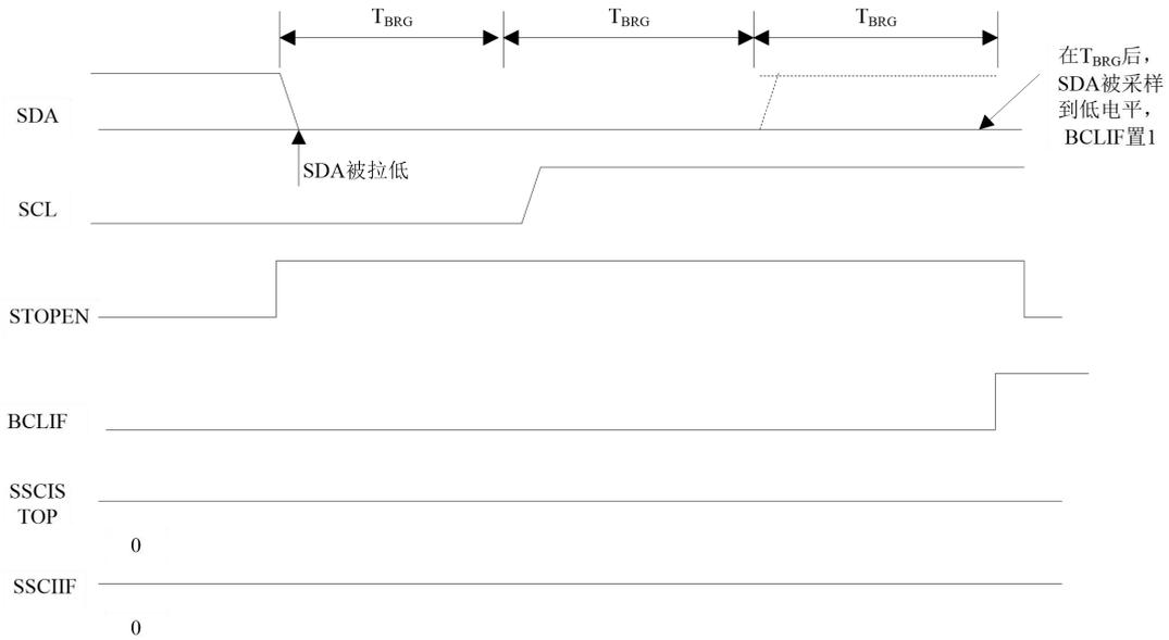
图12.26 停止条件期间的总线冲突（情形1）
