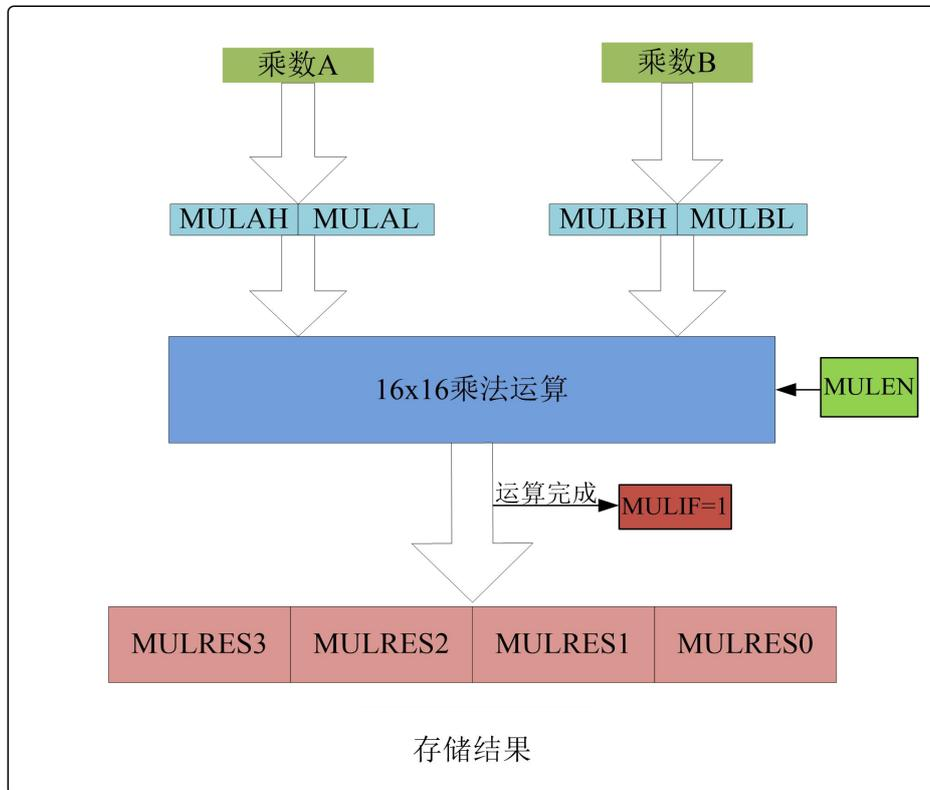
图 13.1  $16 \times 16$  硬件乘法器原理框图
