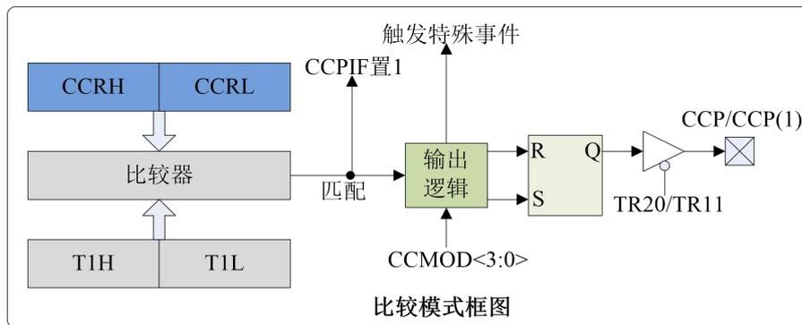
图9.2 比较模式原理框图
