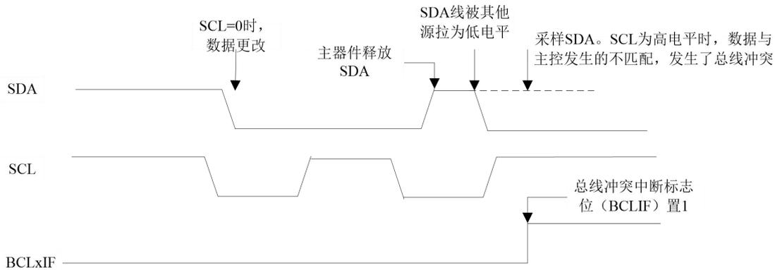
图 12.20 发送和应答时的总线冲突时序
