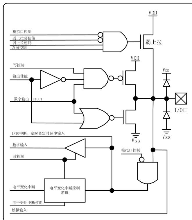
图 2.3 P00~P01、P03~P05 口引脚原理框图
