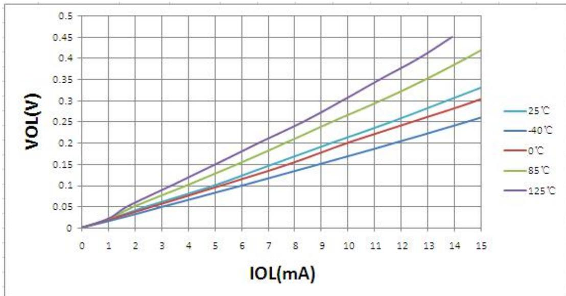
图19-12: 不同温度时VOP—IOP 关系曲线图 (VDD =5.0V)
