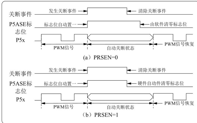
图 9.20 自动重启和软件重启 PWM 示例
