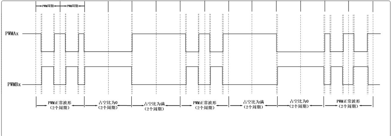
9.13 切换电平示意图（中心对齐模式下）
