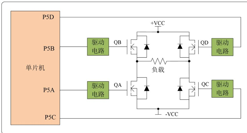
图 9.16 全桥输出模式应用电路示例
