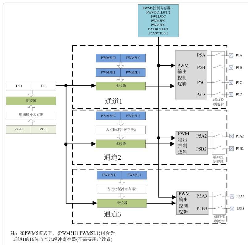
图 9.3 PWM5 原理框图
