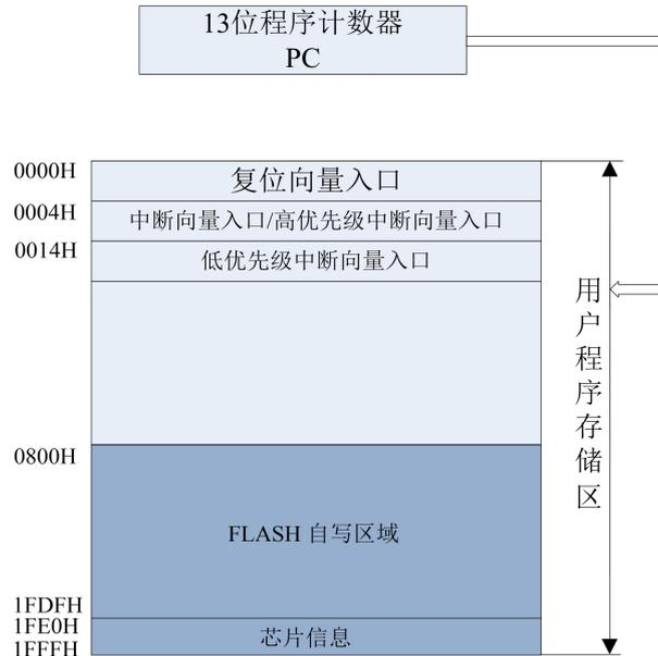
图 3.3 KF8F4158 程序存储器映射
