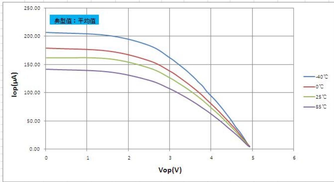
图 19-13: 不同温度时 VOP—IOP 关系曲线图 (VDD =3.3V)
