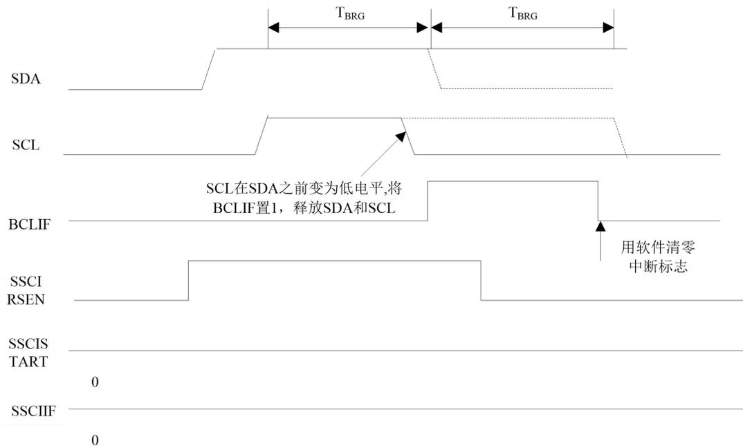
图 12.25 重复启动条件期间的总线冲突（情形 2）
