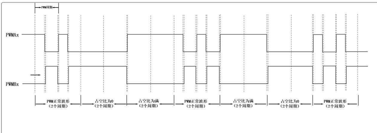
9.12 切换电平示意图（边沿对齐模式下）
